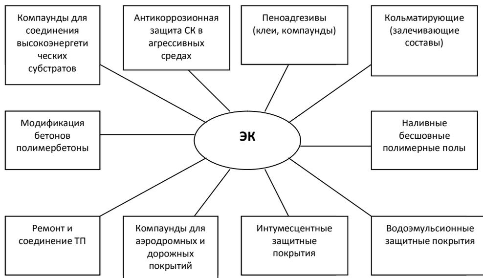
Рис.1. Спектр применения эпоксидных материалов в строительной отрасли
