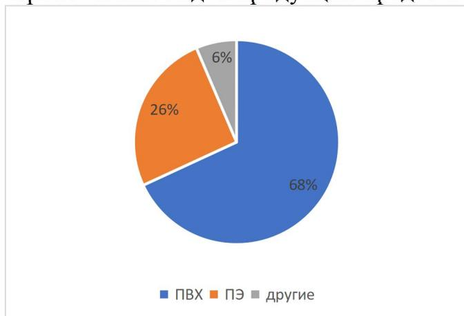
Рис.1. Структура потребления термопластичных полимеров для производства продукции строительного назначения из ДПК
