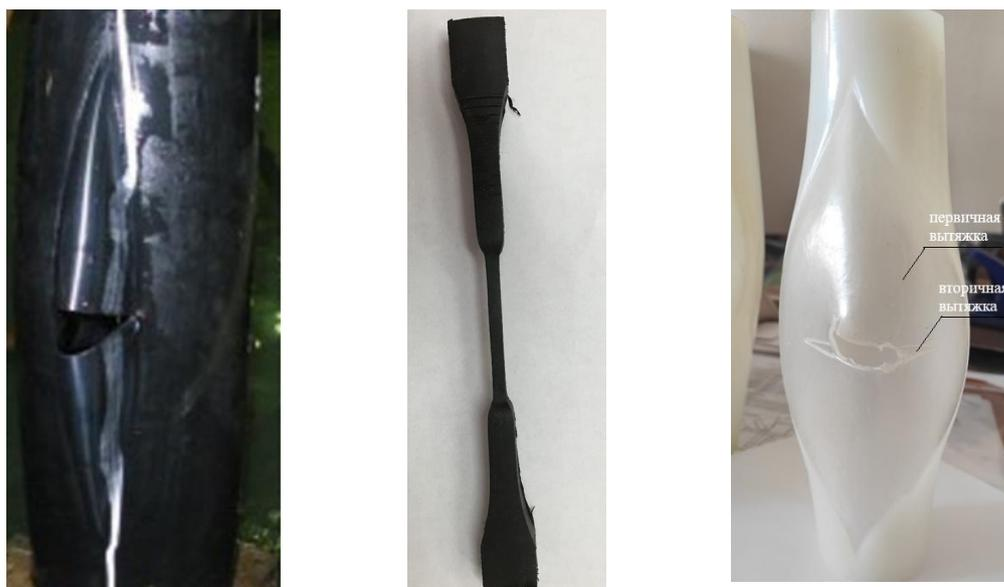
Рис.1. Образцы в форме ПЭ труб и лопаток, проявившие пластическое разрушение при испытаниях под давлением и на растяжение
