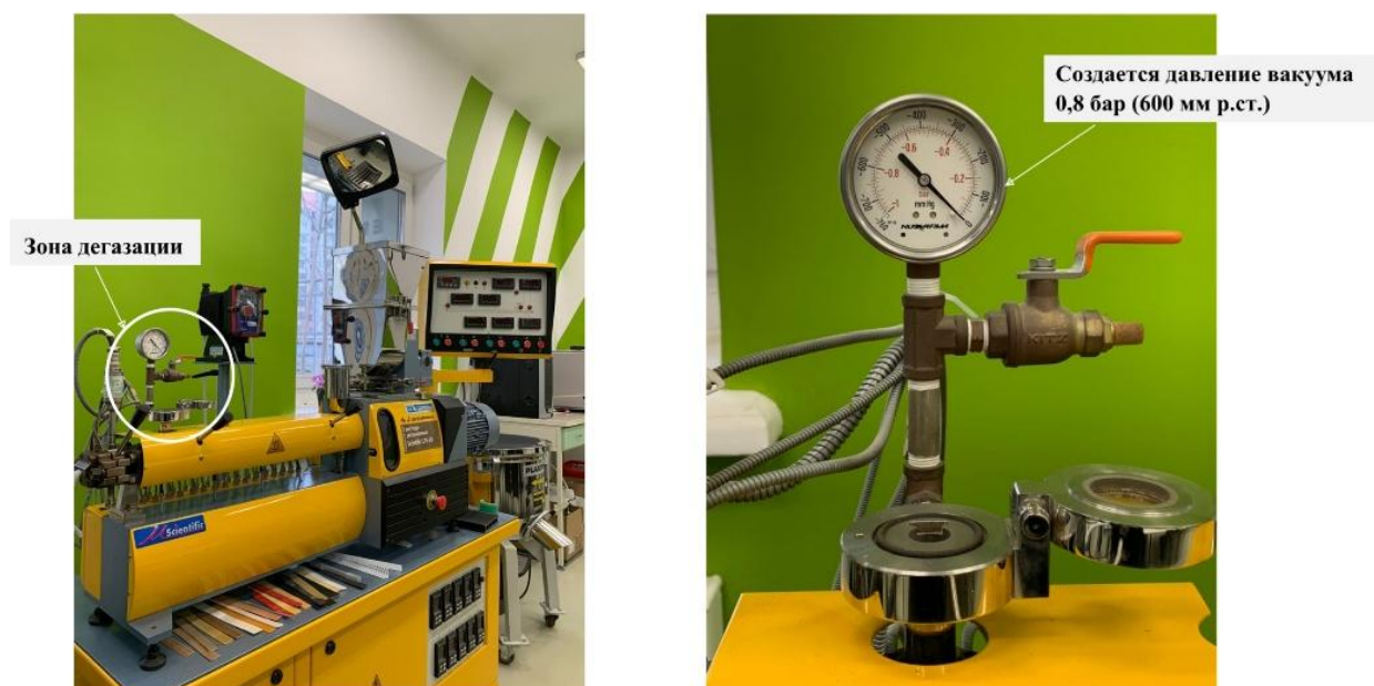
Рис.2. Экструдер LabTech Scientific LTE 16-40 с дегазирующей камерой
