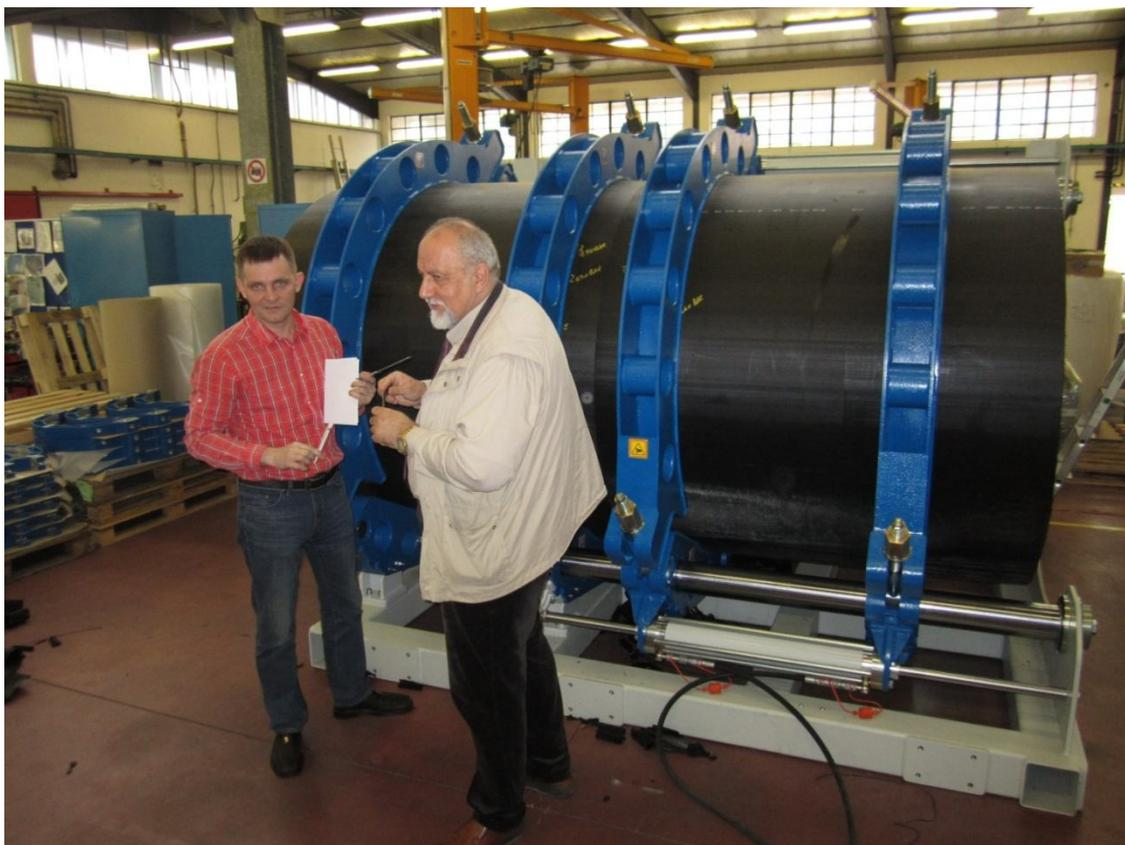
Рис.1. Сварка трубы  $\text{Ø}1600$  мм толщиной свыше 100 мм
