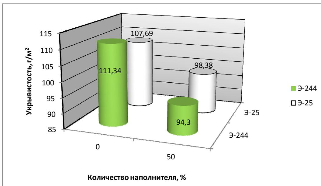
Рис.1. Зависимость укрывистости защитных Пк на основе стирол-акриловых пленкообразователей (Э-244, Э-25) от содержания модифицированного наполнителя
