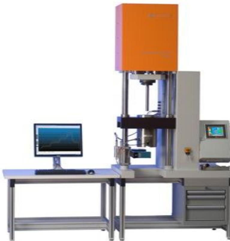
*Рис.8. Двухкапиллярный вискозиметр*
