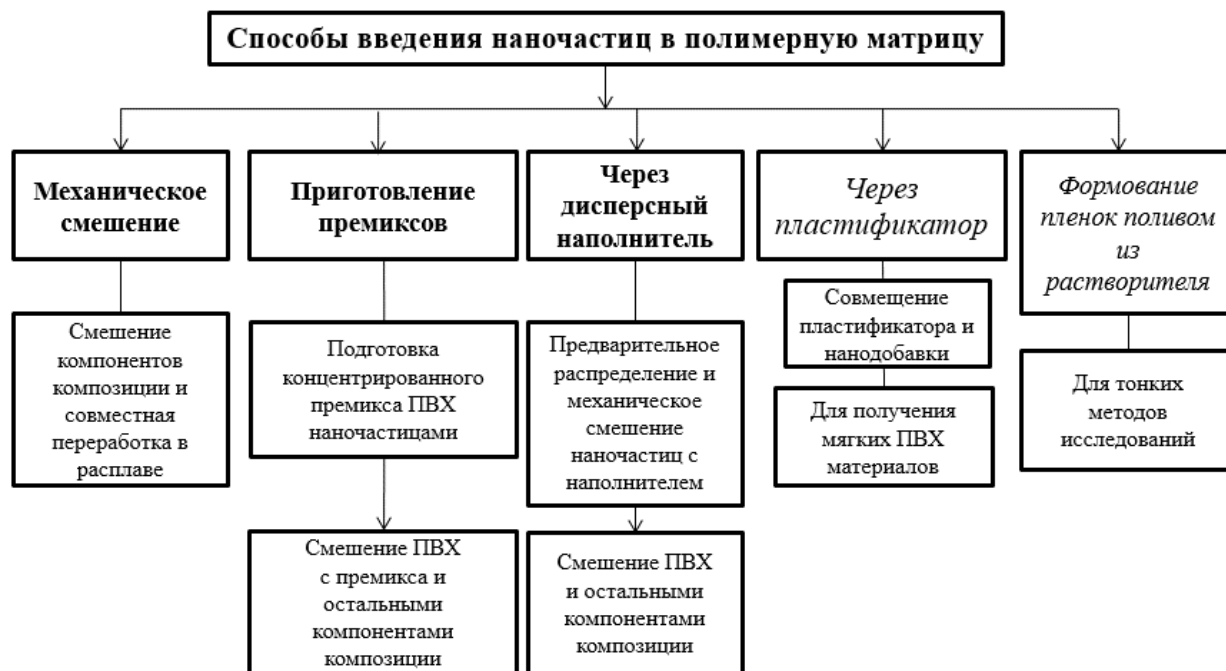
Рис.2.4. Способы введения нанонаполнителей в ПВХ
