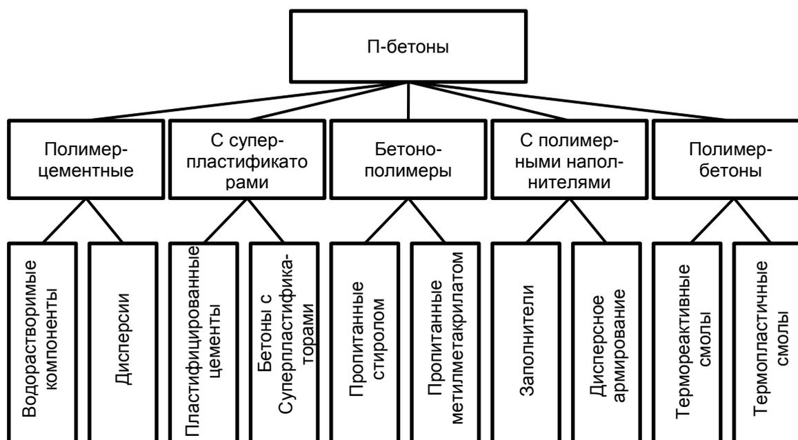
Рис.1. Классификация способов модификации бетонов полимерами
