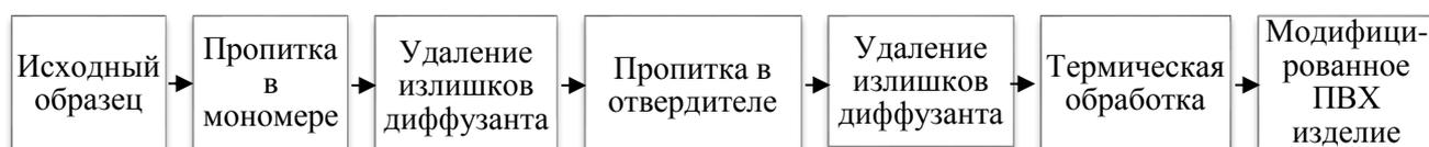
Рис.1. Порядок проведения диффузионного модифицирования винипласта
