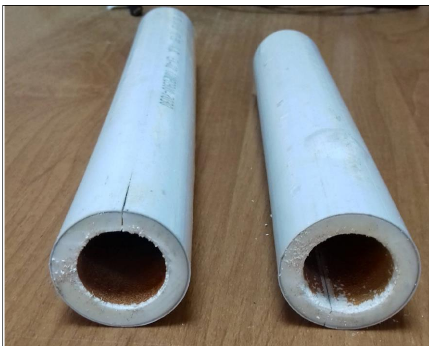
Рис.1. Труба полипропиленовая армированная алюминиевой фольгой из стояка системы горячего водоснабжения жилого дома.
